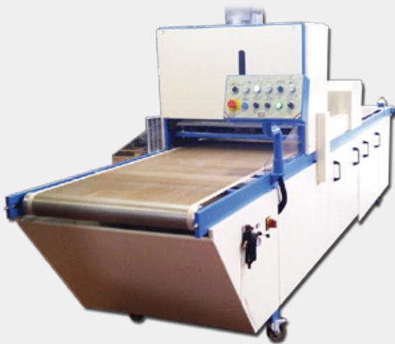
Sistema innovativo per la spolveratura su fogli transfert, dotata di nuovi automatismi per un controllo del flusso e quantità da erogare, ed inoltre con un sistema di ricircolo a coclea inversa per un ciclo di lavoro continuo senza soste.
